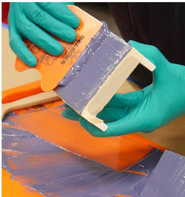
贝尔佐纳 (Belzona) 7311 是一种抗疲劳胶粘剂，适用于需要高机械强度、抗劈裂和抗剪切性能的结构粘接应用。贝尔佐纳 (Belzona) 7311 非常适合于承受循环和重复载荷的粘接应用。
