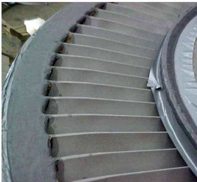
贝尔佐纳(Belzona) 1511(超级高温金属)是一种高温、膏状级修复系统,适用于重建受到侵蚀腐蚀损害的设备。该材料还可用作一种高强度结构粘合剂或者用于形成不规则承重衬片。
