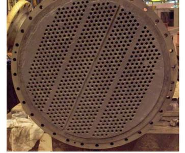
换热器管端面受到严重的电偶腐蚀和点蚀。在敷涂贝尔佐纳(Belzona)高温涂层之前使用贝尔佐纳(Belzona) 1511 进行了重建。
