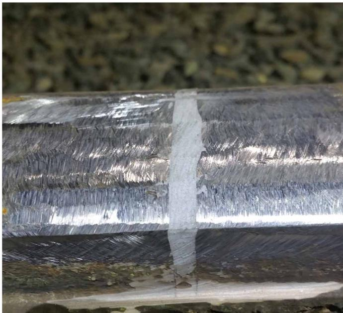
贝尔佐纳(Belzona) 1221 (超级E金属) 是一种双组分、紧急修复复合材料, 以陶瓷钢增强型聚合物材料为原料。这一可完全进行机械加工 的贝尔佐纳(Belzona)产品可用于对金属部件进行永久粘接、修复或重建。
